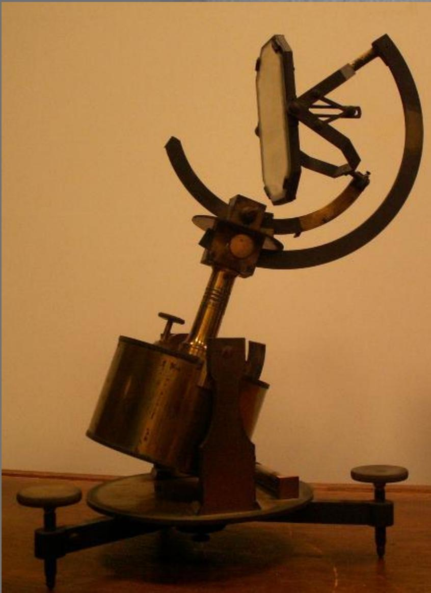
Un miroir, entraîné par un mécanisme d'horlogerie, tourne de telle sorte que le faisceau lumineux qu'il réfléchit, ait une direction fixe par rapport à la Terre, direction indépendante du mouvement apparent du Soleil dans le ciel.
