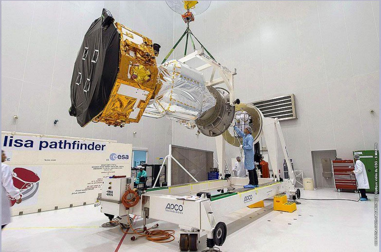
Ce satellite est un démonstrateur devant servir de banc de test pour l'ambitieuse mission eLisa (*evolved Laser Interferometer Space Antenna*), prévue pour 2034 : trois engins séparés d'un million de kilomètres se lanceront alors dans la quête des ondes gravitationnelles, qui se refusent encore aux instruments terrestres.
