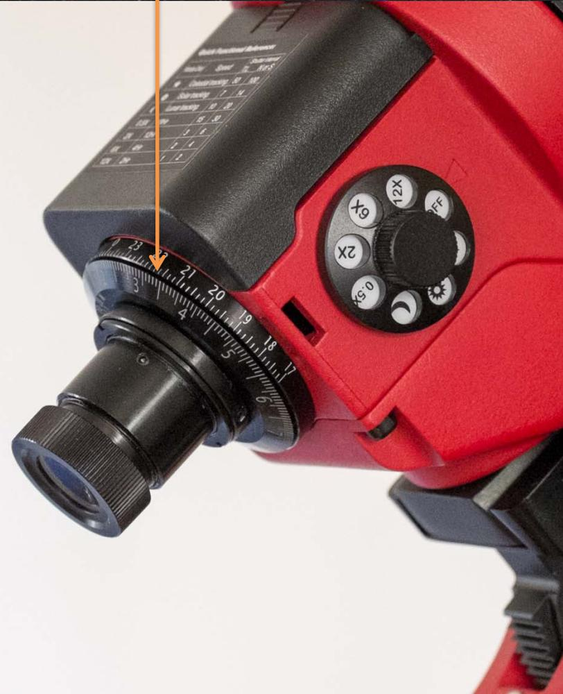
5 : Grâce aux **réglages fins de latitude** et d'**azimut**, faites rentrer l'étoile polaire dans le viseur. Jouez éventuellement avec l'orientation azimutale du pied en prenant garde de conserver l'horizontalité de la monture !
