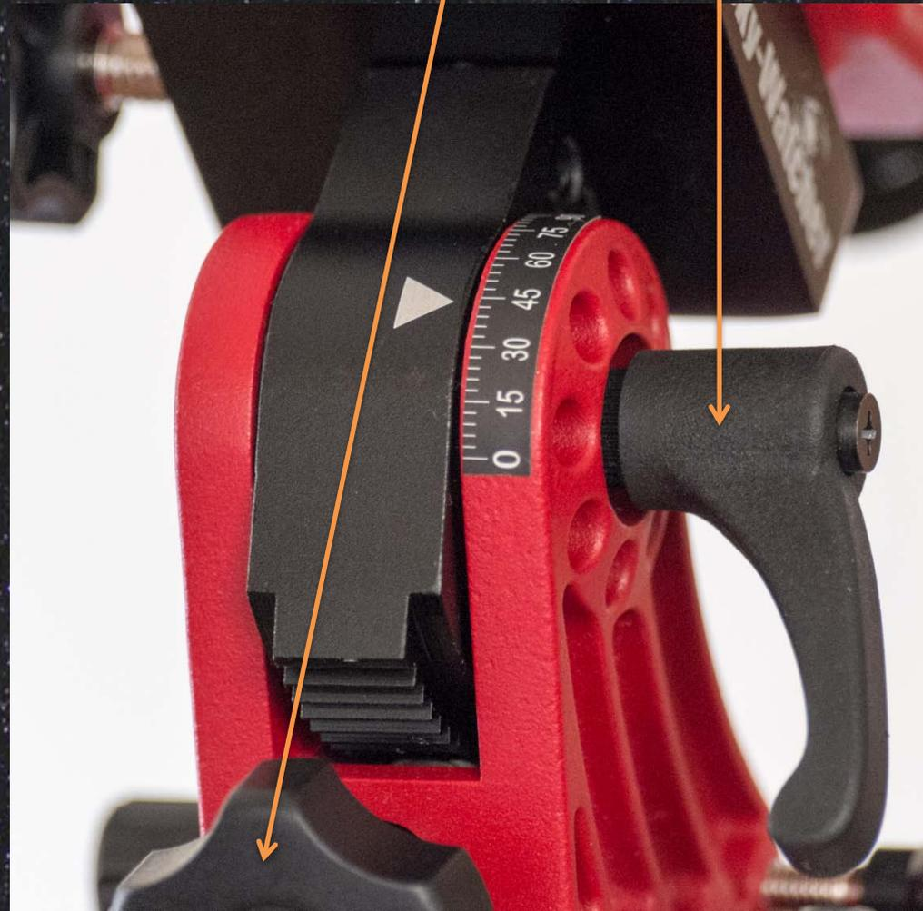
4 : En desserrant **le frein** et en faisant **pivoter l'axe polaire**, faites correspondre l'heure TU et la date d'observation.
