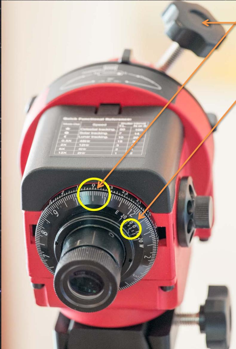
a) Faites tourner le **cercle de date (gradué jusqu'à 12)** pour le régler à la date du 31 octobre à 0h00.
